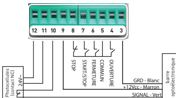
Pour connecter la photocellule, cette dernière doit être connectée comme indiqué dans la photo (**DIP 4 en OFF**).
