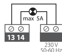
Si elle se voit attribuer un code radio à la lampe de courtoisie, l'envoi de la commande provoque l'activation du relais pendant 3 minutes et 2 secondes en fonction de la programmation du panneau de commande. En cas d'envoi du relais de commande est déjà active désactivera le relais.
