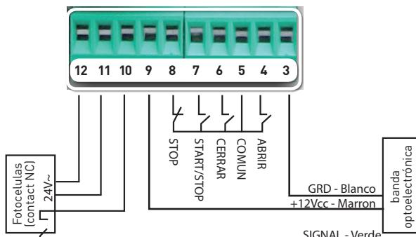
Para conectar la célula fotoeléctrica como se muestra en el esquema (**DIP 4 en OFF**)
